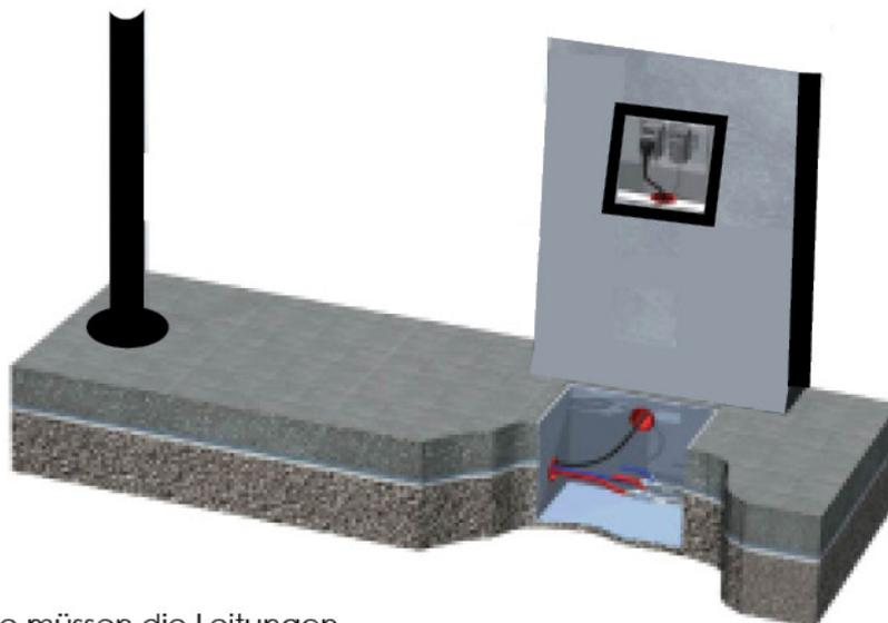
Für eine ganzjährige Nutzung der Edelstahldusche müssen die Leitungen und Armaturen vor dem Frost geschützt werden. Die Heizung verhindert das Einfrieren der inneren Leitungen.
