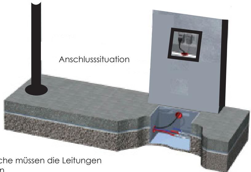
Für eine ganzjährige Nutzung der Edelstahldusche müssen die Leitungen und Armaturen vor dem Frost geschützt werden. Die Heizung verhindert das Einfrieren der inneren Leitungen.
